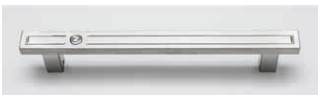
Pochwyty poziomy WOBİ LIVELLO . Stal nierdzewna, szlifowana, profil 40x20mm. Frezowany i polerowany rowek, linia lub bez frezowania. Przycisk podświetlany z przodu, bez podświetlenia z tyłu lub bez przycisku.
